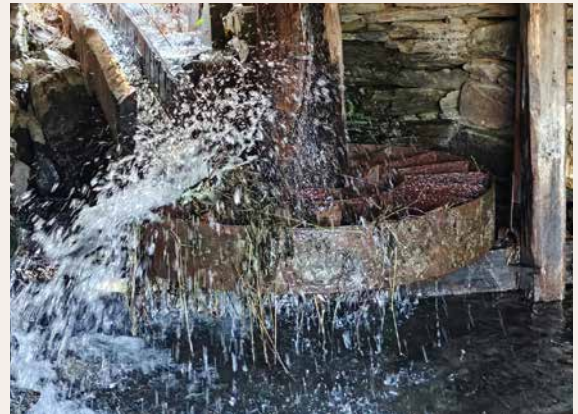
Detalle de la rueda que mueve el molino de pan.
